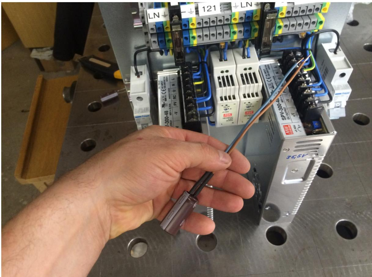
Der Anschluss des Kondensators erfolgt mit Minus (Farbe blau) an -V und Plus (Farbe braun) an Eingang PV des Netzgerätes.
